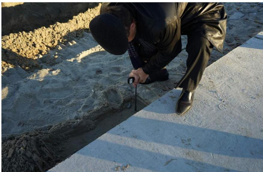
*Рис. 2 – Проверка коэффициента уплотнения в песчаном слое статическим плотномером СПП-1М*
