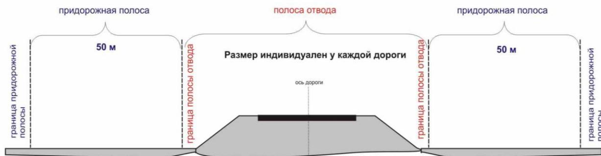
Рис. 2 – Схема расположения полосы отвода и придорожных полос для автомобильных дорог (на примере третьей и четвертой категорий)
