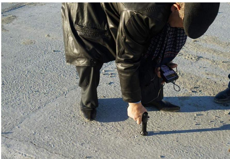
*Рис. 3 – Проверка прочности бетона измерителем прочности бетона ИПС-МГ4.03*
